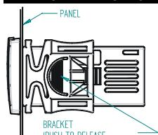
Instrumentul XR20CX se monteaza pe un panou, intr-o decupare de 29x71 mm, si fixat folosind bratele speciale.
